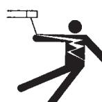
**CHOQUE ELECTRICO --** El contacto con las partes eléctricas energizadas y tierra puede causar daño severo o muerte. NO use soldadura de corriente alterna (AC) en áreas húmedas, de movimiento confinado en lugares estrechos o si hay posibilidad de caer al suelo.
