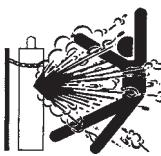
**MANIPULATION DES CYLINDRES -- La manipulation d'un cylindre, sans observer les précautions nécessaires, peut produire des fissures et un échappement dangereux des gaz.**
