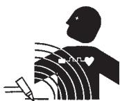
**CAMPOS ELECTRICOS Y MAGNETICOS** - Son peligrosos. La corriente eléctrica fluye através de cualquier conductor causando a nivel local Campos Eléctricos y Magnéticos (EMF). Las corrientes en el área de corte y soldadura, crean EMF alrededor de los cables de soldar y las maquinas. Por lo tanto:
