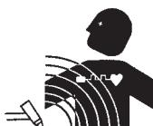
**CHAMPS ÉLECTRIQUES ET MAGNÉTIQUES — comportent un risque de danger. Le courant électrique qui passe dans n'importe quel conducteur produit des champs électriques et magnétiques localisés. Le soudage et le courant de coupe créent des champs électriques et magnétiques autour des câbles de soudage et l'équipement. Par conséquent :**
