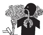
**HUMO Y GASES -- El humo y los gases, pueden causar malestar o daño, particularmente en espacios sin ventilación. No inhale el humo o gases. El gas de protección puede causar falta de oxígeno.**
