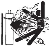
**MANEJO DE CILINDROS-- Los cilindros, si no son manejados correctamente, pueden romperse y liberar violentamente gases. Rotura repentina del cilindro, válvula, o válvula de escape puede causar daño o muerte. Por lo tanto:**
